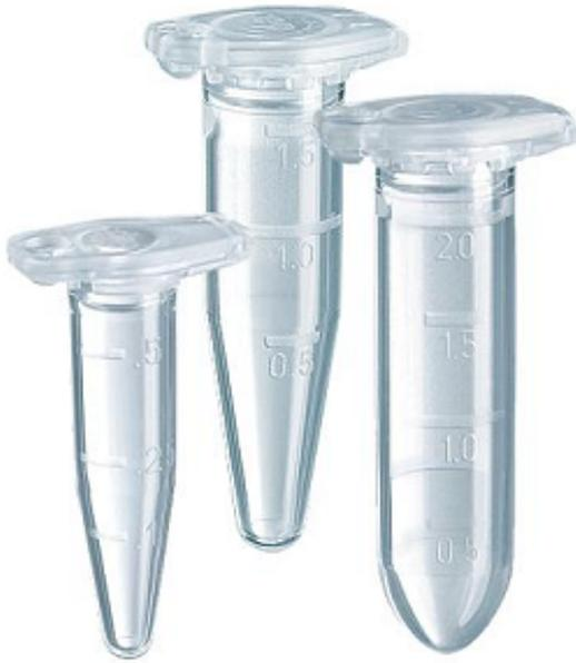
Contenant en plastique de 1,5ml pour prélèvement d'échantillon du poinçon EP-AT-7000
