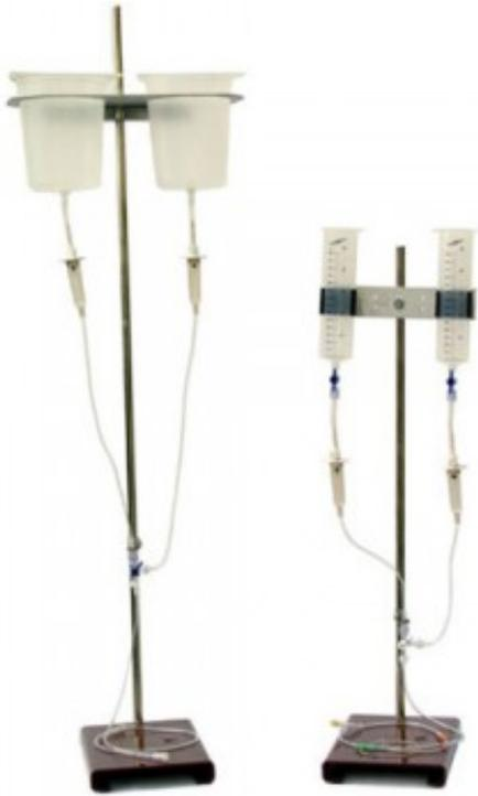
Des résultats fiables – l'administration constante par gravité du tampon et du fixatif permet une perfusion complète
