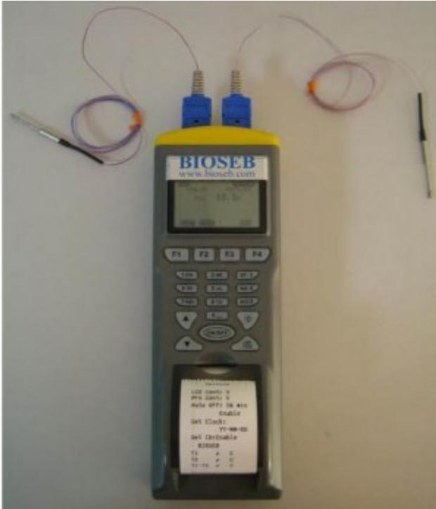
Le thermomètre TK9882 de BIOSEB mesure la température corporelle avec une imprimante thermique intégrée.
